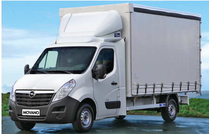
Fahrzeuginformation: Opel Movano Fahrgestell L3H1 mit Frontantrieb; der Aufbau wird auch für alle anderen Fahrgestelllängen angeboten. Zulässige Gesamtmasse: 3,5 oder 4,5 t
